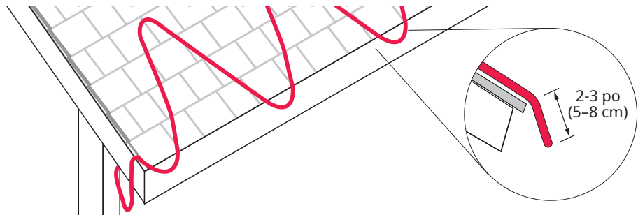
Figure 6 Disposition pour les boucles d'égouttement chauffantes
