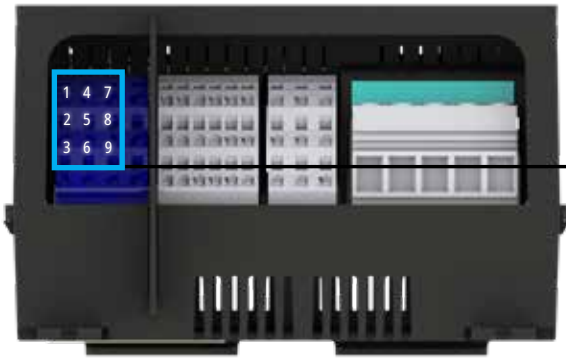
Искробезопасное подключение клемм датчика температуры
