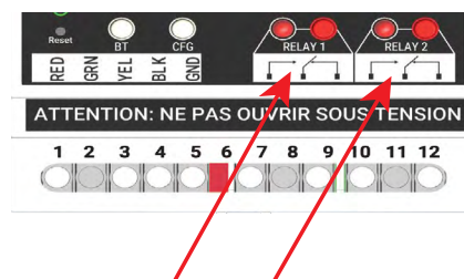
Abbildung 6: Anschlüsse der Alarmrelais Die Beschriftung zeigt den Relaiszustand, wenn das TTSIM-3/4 eingeschaltet ist, keine Alarme anliegen und der Relais-Alarmzustand auf „Aus“ programmiert ist (Werkseinstellung).
