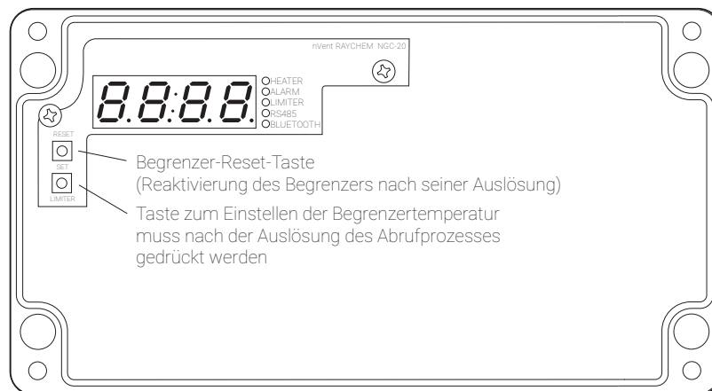
Abbildung 11: Interne Reglertasten des Begrenzers: Begrenzer-Drucktasten (Temperatur) SET und RESET
